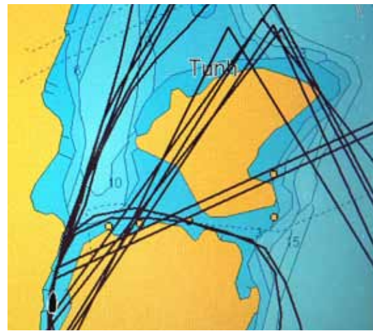
Så här ser det ut när navigatorn lagrar spår som har för stora avstånd mellan varje punkt. Inget att rekommendera i skärgårdsnavigering. Vidare bör man se upp så att navigatorn inte lagrar spår varje gång man kör ut och in i samma hamn.
